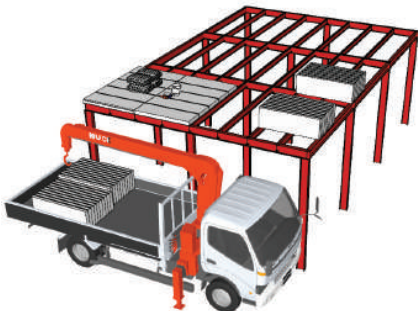
Bước 1: Cầu tấm lên vị trí sàn thi công và rải tấm trên kết cấu thép.
